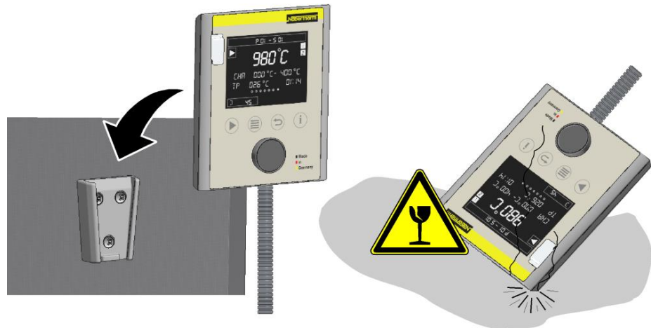
Fig. 31: Sette styringen inn i holderen på ovnen (illustrasjonen kan avvike)
