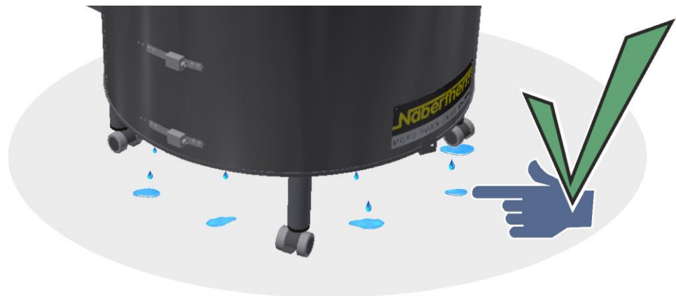
Fig. 26: Kondensansamlinger under de første brenningene (illustrasjonen kan avvike)
