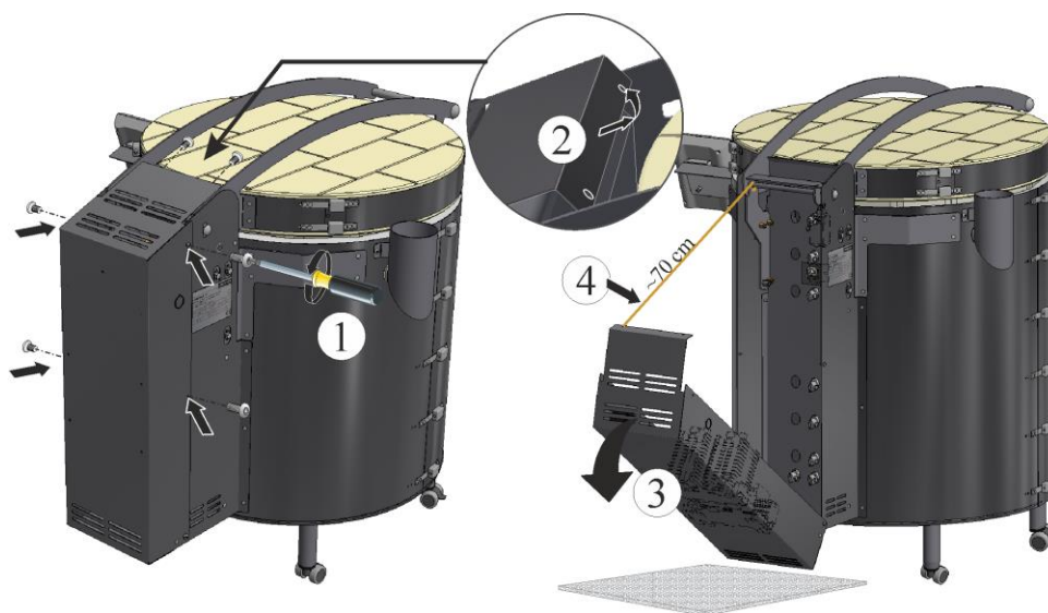
Fig. 47: Demontere koblingstavlepanelet fra ovns bakside (illustrasjonen kan avvike)
