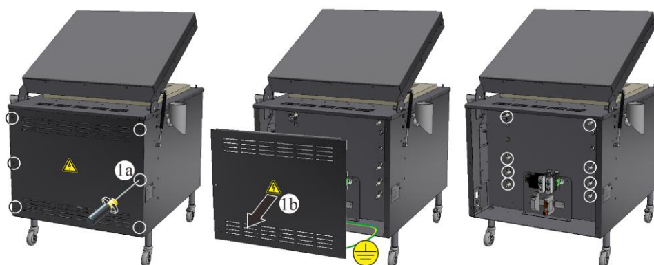
Fig. 59: Demontere koblingstavlepanelet fra ovns bakside (illustrasjonen kan avvike)
