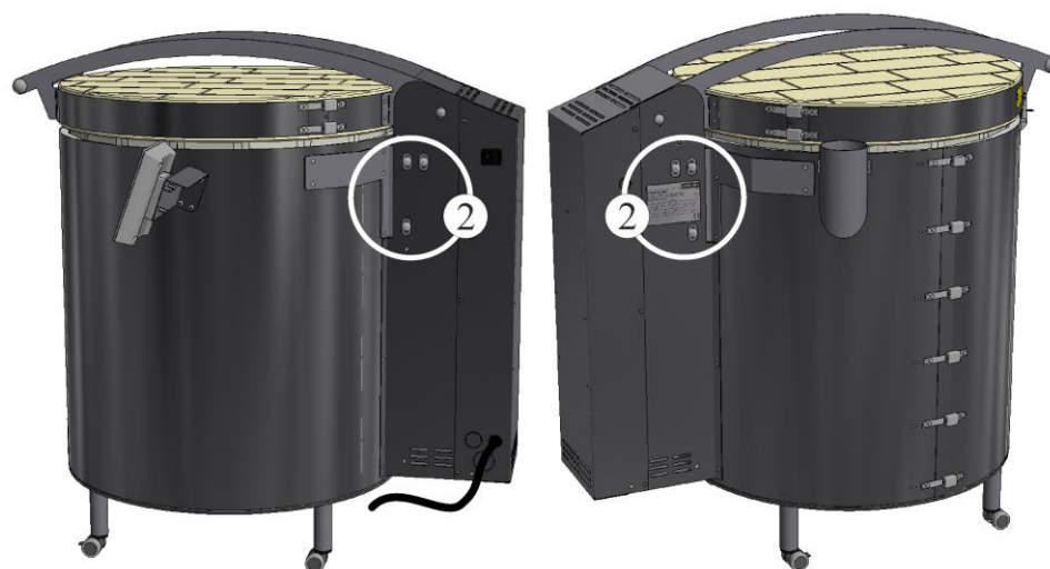
Fig. 40: Skruer for å stille inn dekslet (illustrasjonen kan avvike)
