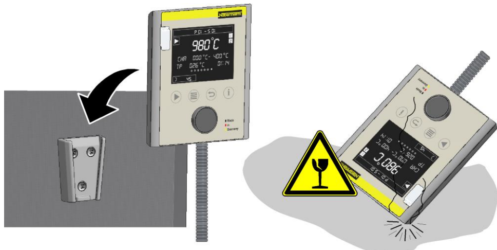
Fig. 18: Sette styringen inn i holderen på ovnen (illustrasjonen kan avvike)
